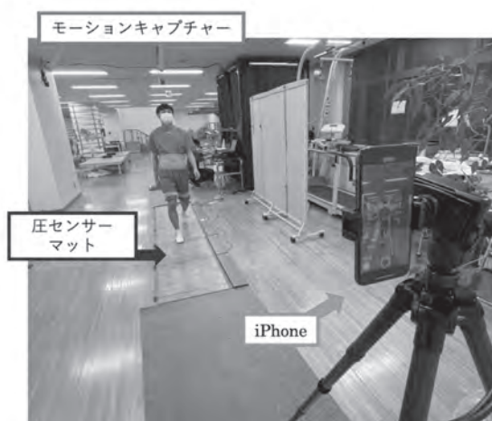
被検者の歩行は正面及び右側面に設置された2台のiPhone X、6台の赤外線式モーションキャプチャー、圧センサーマットで同時撮影した。本報告では、右側面から撮影したデータのみを取り扱う
